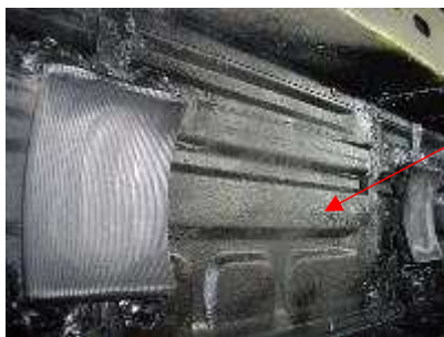
Soportes depósitos integrados en chasis
